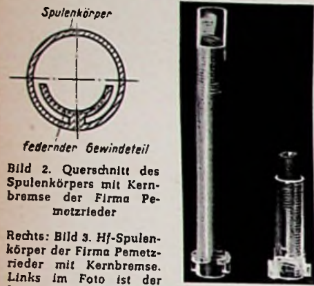
Bild 2. Querschnitt des Spulenkörpers mit Kernbremse der Firma Pemetzrieder
